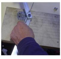
台形プレートの8mm貫通穴に $\underline{\underline{\mathbf{E}}}$ )入れこの部分を基準として曲げ棒を回すのと有効です
