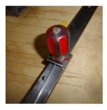
コイルの内径を変えることもできます。付属の要ピンを使わず。ドライバー等を要ピンとするとドライバーの直径がコイルの内径となります。
