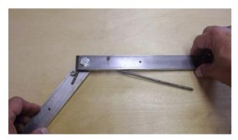
基本使用例その2:台形プレートで曲げる
