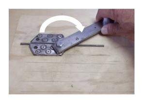
曲げる剛線が細、あるいは柔らかい物で、<u>曲半径を小さくしたい場合は曲げ棒 S、太い剛線、硬い物の場合は曲げ棒 L</u>と使い分けます。 $\underline{5\,mm$  ビスのビス頭で曲げます。要ピンは短い物を使用します。
