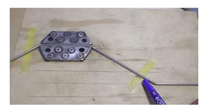
加工したい剛線の曲げ角度を基準とせず、基準となる一本目の剛線を曲げた時、曲げ位置をマーキングし次の剛線を同じ条件でマーキングまで曲げる
