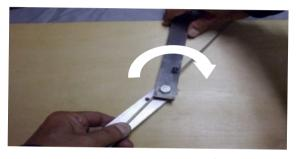
きれいな丸いコイルをつくるには、<u>要ピンに材料が巻き込まないようにする</u>ことです。方法としては材料の端を細い物はU字あるいはL字に加工して曲げ、加工する棒材が要ピンに巻き込まれないようにしっかり維持します。巻きこまれるのは1周目だけです。
